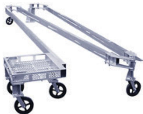
Складной кабельный удлинитель "Zig-Zag" предназначен для хранения и облегчения перемещения питающего кабеля от аэродромного преобразователя 208В/400Гц или аэродромного выпрямителя 28В к воздушному судну во время его наземного обслуживания.
