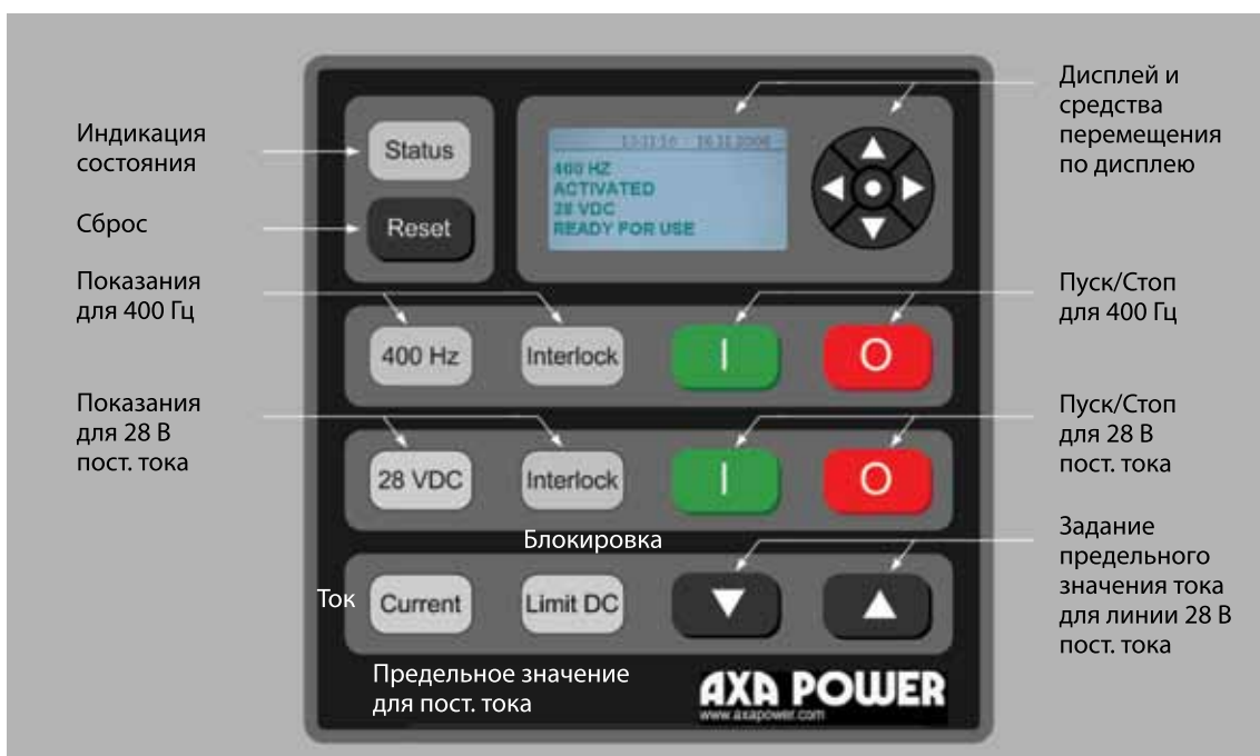
Рис. 6.2. Пульт управления для агрегата с дополнительным (устанавливается по отдельному заказу) выходом для напряжения 28 В постоянного тока
