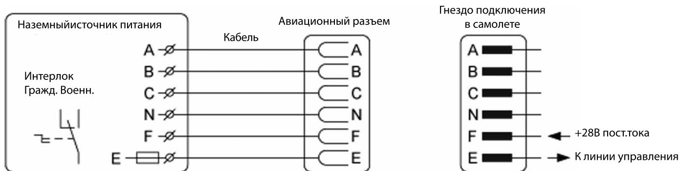
Стандартная схема подключения военного воздушного судна.
