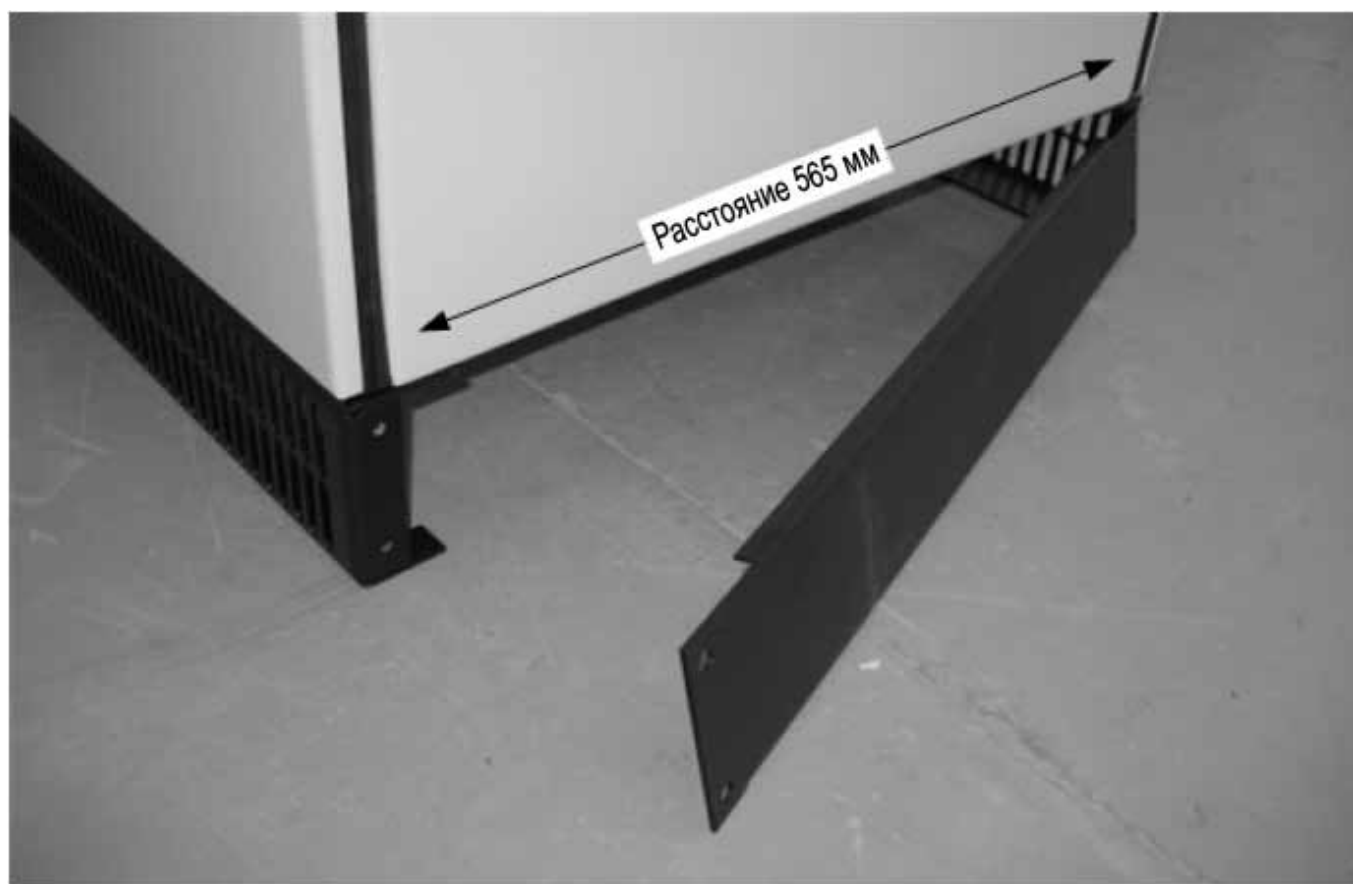
Рис. 4.3.1. Обеспечение доступа для вилочного подъёмника, автопогрузчика с вилчатым захватом и т.п. Для обеспечения доступа нужно открутить и снять 8 винтов.
