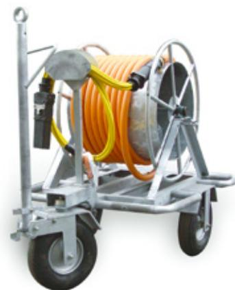
**Аэродромный мобильный кабельный удлинитель "GR"** предназначен для транспортировки, хранения и перемещения кабеля напряжением до 1000В переменного тока 50/400Гц или постоянного тока 28В/600А.
